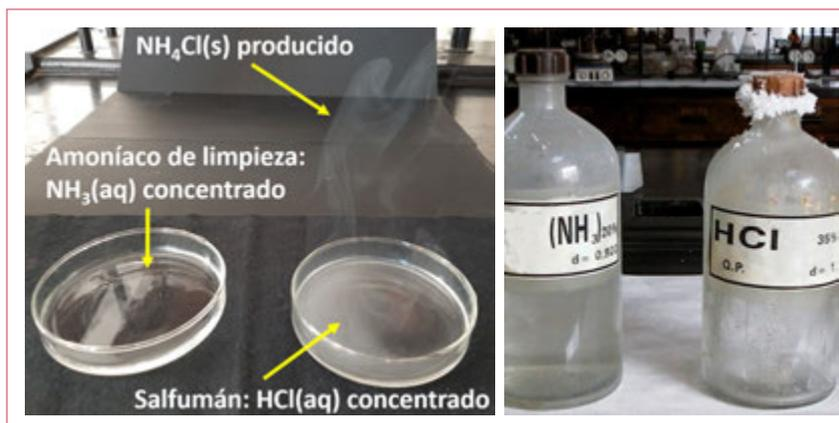
Figura 1. Formación de NH<sub>4</sub>Cl(s): a la izquierda en forma de microcristales que producen una «neblina» y a la derecha en el tapón de la botella con HCl(aq).
