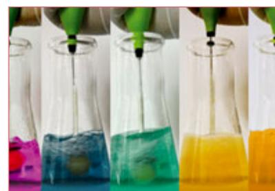
Figura 5. De izda. a dcha.: variación de colores causada por las especies con distinto estado de oxidación del manganeso, al reducirse de  $\text{MnO}_4^{-}(\text{aq})$  a  $\text{MnO}_2(\text{s})$  en suspensión, en medio alcalino, por la acción reductora de un chupachup.
